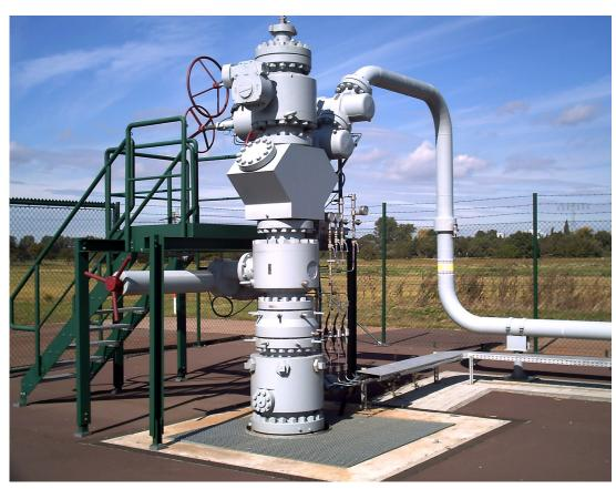
Wellhead high pressure Hartmann Valves GmbH CC https://commons.wikimedia.org/wiki/File:Wellhead\_Bohrlochkopf.JPG
